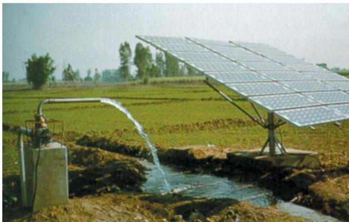
Figura 119 – Utilização de energia solar na alimentação de bombas hidráulicas<sup>109</sup>
